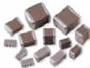
左下図のように、とても小さいコンデンサで、携帯電話をはじめとした様々な電子機器で使用されている。村田製作所などで作られる。
