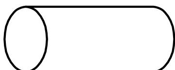
②ガラスロッドを  $\text{KNO}_3$  溶融塩 (350~400°C) に浸す (Tl と K のイオン交換)
